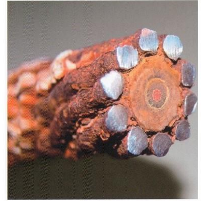
(b) 海底ケーブルの断面図。1871年に長崎とウラジオストック間に敷設 出典；KDDI
