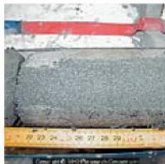
砂質層孔隙充填型メタンハイドレート
